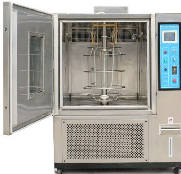
FIGURE 2.21 – Enceinte de vieillissement UV utilisée [54]
