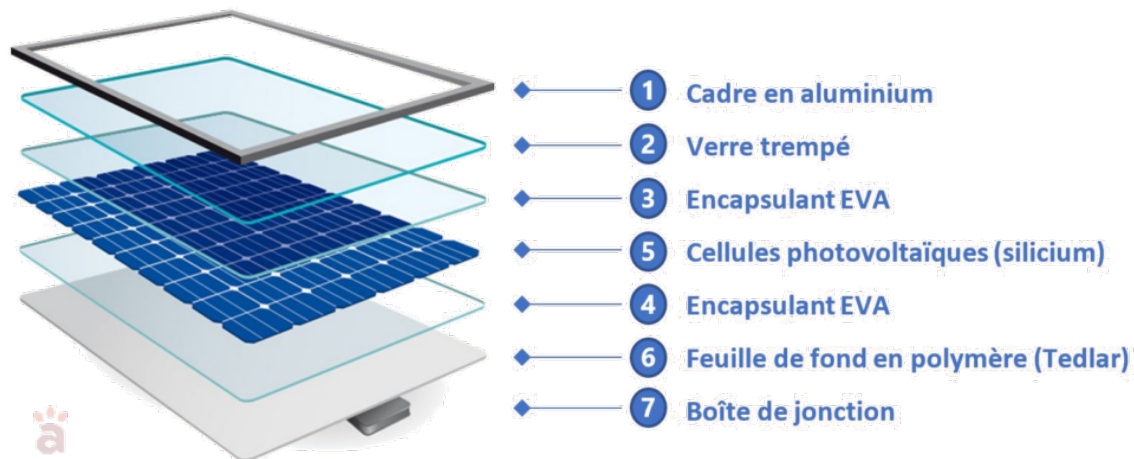
FIGURE 1.7 – Éléments constituant un module PV [10]
