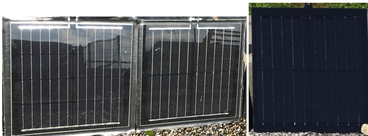
FIGURE 4.1 – De gauche à droite : Module avec cellules HET, encapsulant noir, verre sodo-calcique, interconnexions brillantes ; Module avec cellule PERC, encapsulant noir, verre sodo-calcique, interconnexions brillantes ; Module avec cellule PERC, encapsulant noir, verre texturé interfloat, interconnexions noires
