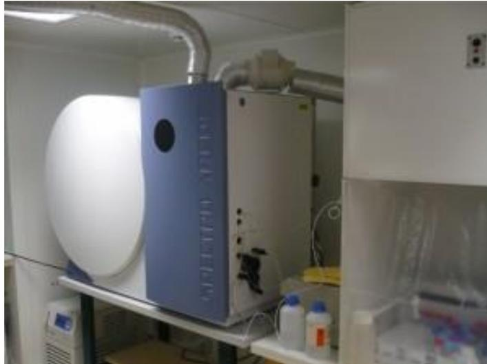
**Figure 2.15.** Spectromètre d'émission atomique à plasma à couplage inductif (ICP –AES) à l'Université Paris Cité. À droite se trouve la HFL de norme ISO 1 où sont positionnés le passeur et les échantillons à analyser.
