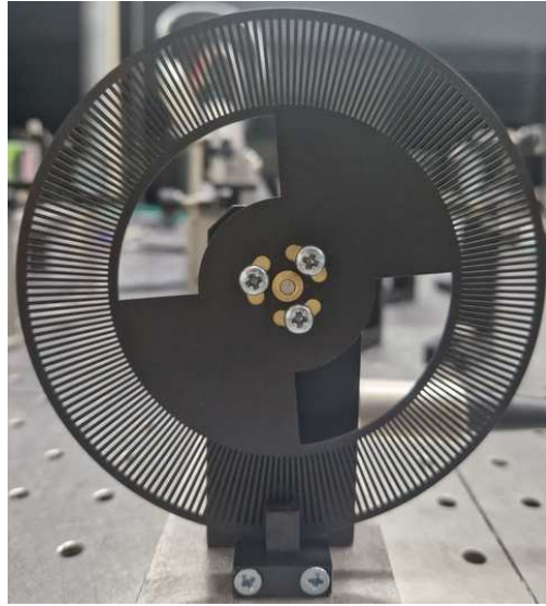
FIGURE 3.20 – Disque fabriqué comportant deux trous au centre et 200 à l’extérieur.
