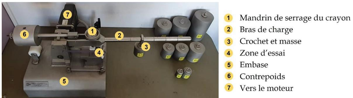
**Figure IV.3: vue d'ensemble du dispositif FSKM 10 de mesure de sensibilité à la friction**
