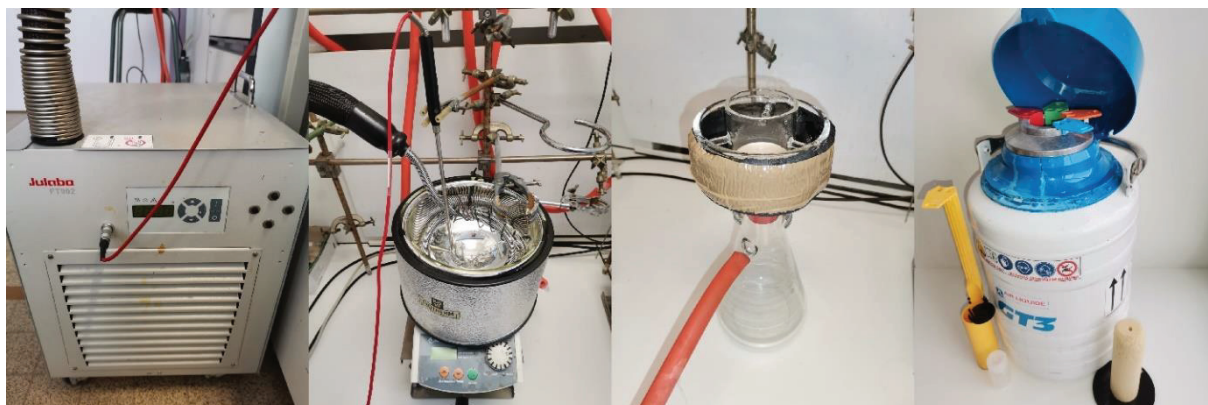
Figure II.3 : de gauche à droite : photo du cryoplongeur (groupe froid) ; photo du cryoplongeur (sonde + bain + canne) ; photo du système de filtration avec verre fritté à double-enveloppe ; photo du Dewar de stockage des arylpentazoles.
