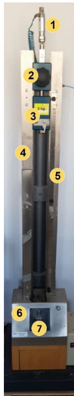
Figure IV.1 vue d'ensemble du dispositif BFH 10 de mesure de sensibilité à l'impact
