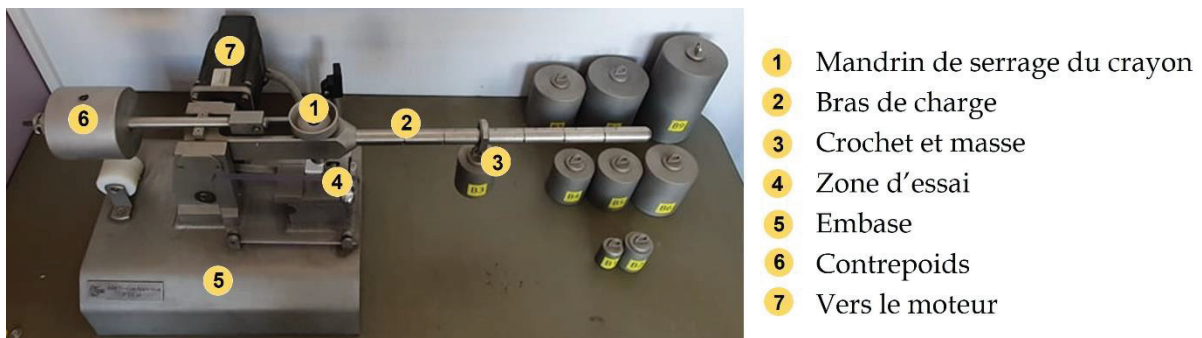
Figure IV.3: vue d'ensemble du dispositif FSKM 10 de mesure de sensibilité à la friction
