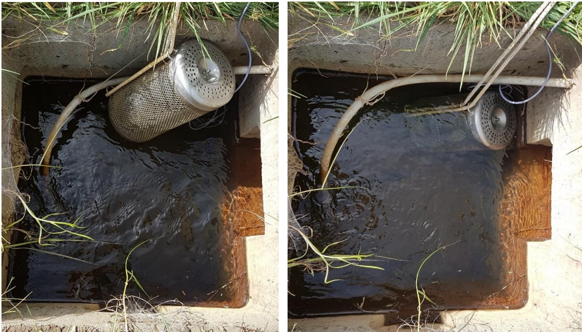
Figure II.13 : Photographies visualisant les positionnements de la cage dans le regard aval, à gauche avant immersion et à droite pendant l'échantillonnage.
