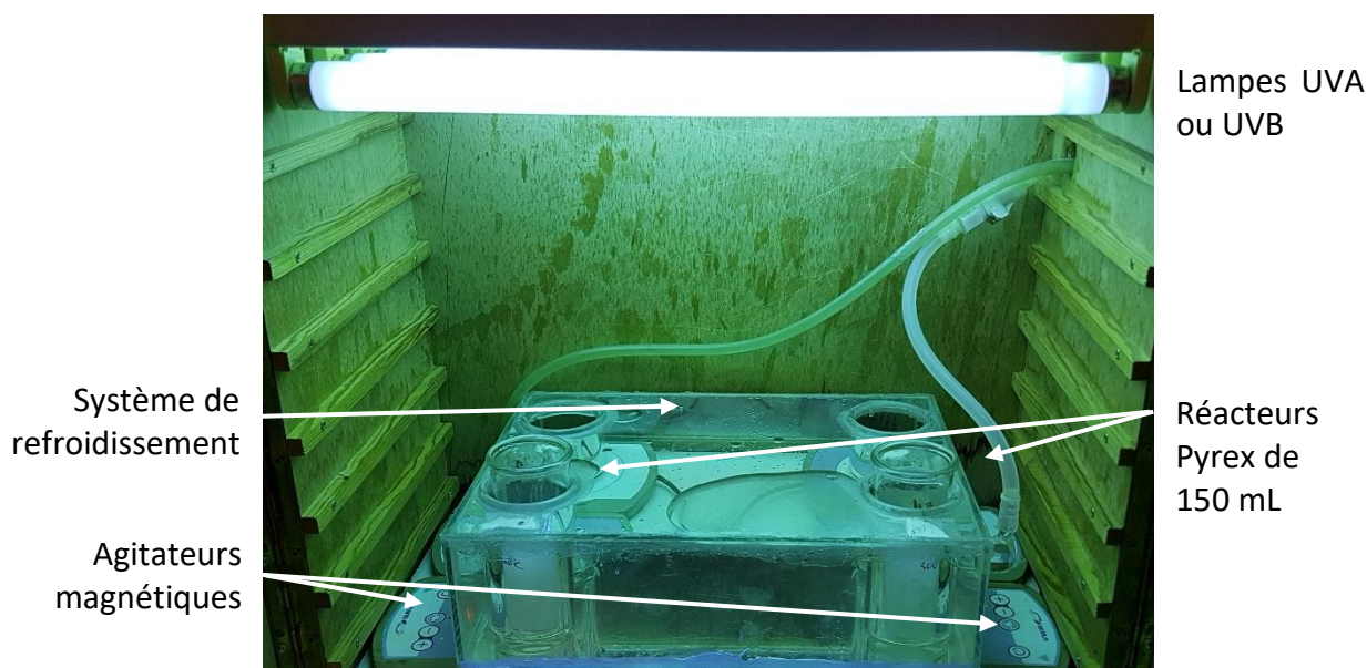
Figure II.3 : Dispositif utilisé lors des expérimentations sous rayonnement UVA ou UVB lors de l'étude menée à l'échelle du laboratoire.
