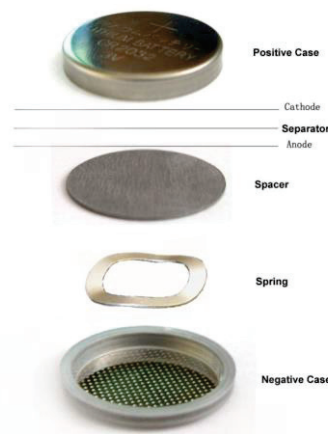
Figure II.3 : Constituant de la pile bouton
