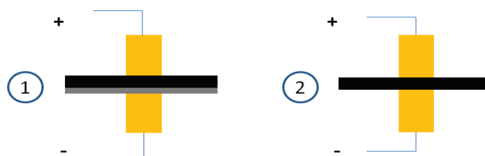
Figure II.13 : Etude de la variation de la conductivité du mélange MCL 82-8-10 en présence du substrat Al (1 : Cathode (MCL+Al), 2 : Mélange MCL)
