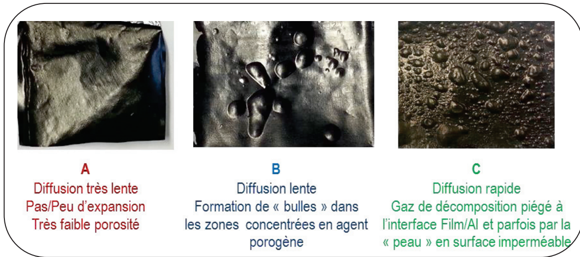
Figure IV.12 : Influence du protocole thermique sur la libération du gaz de décomposition de l'ABFA
