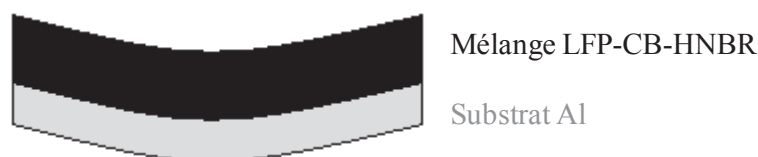
Figure II.6 : Schéma de la courbure de la cathode due au retrait du polymère
