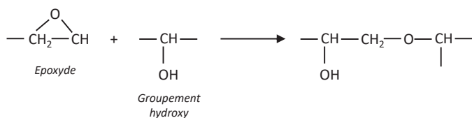
Figure II-1. Réactions principales attendues d'un époxy avec une amine primaire et avec un groupement hydroxy
