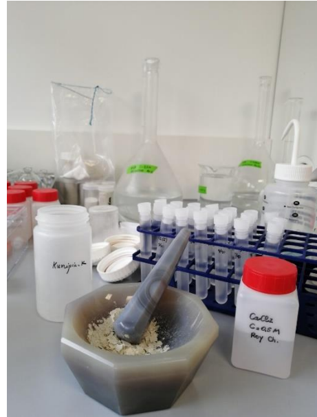
Figure II.5: Broyage manuel de la Kunipia dans un bol en agate.
