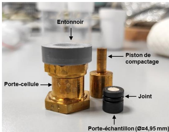
Figure III.22: Smectite compactée à l'intérieur du porte-échantillon en PEEK
