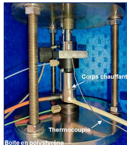
Figure III.15: Cellule chauffée avec un corps chauffant
