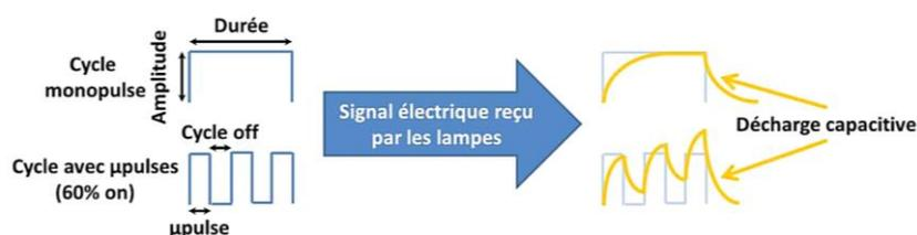
Figure A182 – Principe de fonctionnement des décharges capacitives sous forme de pulses <sup>10</sup>
