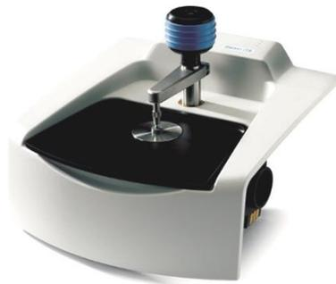
Figure A172 – Accessoire Smart iTR de l'équipement Nicolet utilisé
