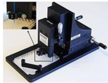
Figure 150 – Dispositif K-light développé, permettant l'approche fine d'une fibre au contact de cellules
