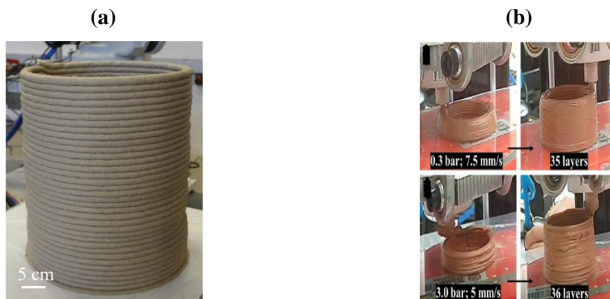
Figure 5 : (a) pièce géopolymère imprimée 3D d'épaisseur 1,8 cm, diamètre 35 cm et hauteur 45 cm [34] et (b) pièces géopolymères imprimés en 3D avec différentes pressions et vitesses d'extrusion [35].
