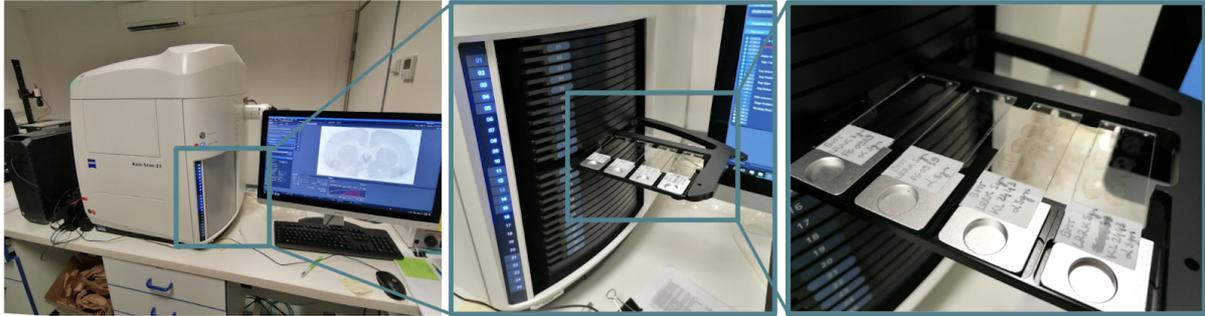
**Figure 21 : Scanner de lames virtuelles AxioScan.Z1 avec grossissement sur plateaux quatre lames** (plateforme de numérisation du CEA-MIRCen).
