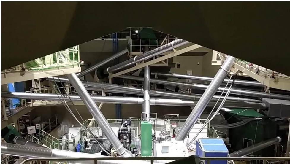
Figures 4.7 : Photographies des chambres expérimentales de l’installation laser GEKKO XII située à l’université d’Osaka au Japon. Celle du haut est la chambre 1, celle du bas est la chambre 2, chambre que nous avons exploitée. Nous pouvons notamment voir les conduits tubulaires marquant la trajectoire de chacun des douze faisceaux. Crédits : Université d’Osaka – ILE, Y. Benkadoum.
