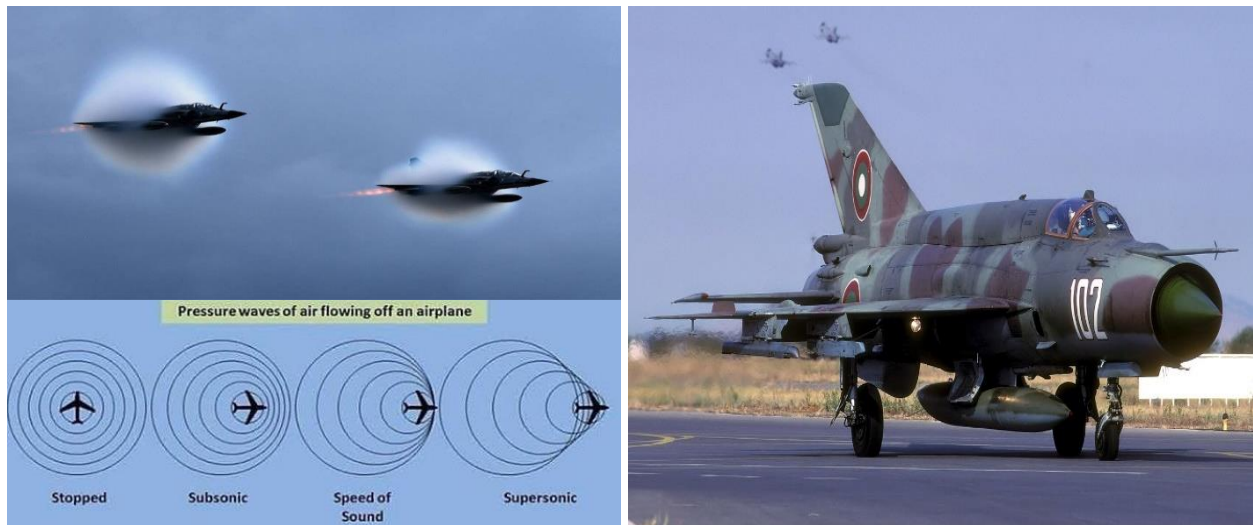
Figures 2.1 et 2.2 : A gauche, une double illustration montrant dans sa partie supérieure, deux avions de chasse mirage 2000 de l'armée de l'air française franchissant le mur du son, et schématisant dans sa partie inférieure, le phénomène du mur du son qui correspond à la transition du vol d'un aéronef d'une vitesse subsonique à une vitesse supersonique. L'illustration de droite est une photographie d'un Mig 21 bis, désignation OTAN : fishbed, de l'armée bulgare. Cet avion supersonique de fabrication soviétique a équipé la flotte des armées de nombreux pays. Crédits : Philippe Goemaere et http://www.airliners.net
