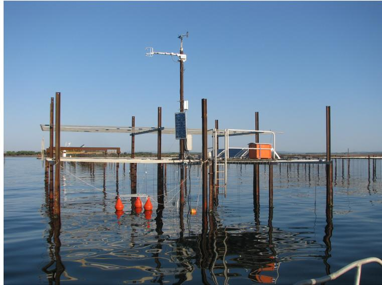
FIGURE 2.3 – Dispositif instrumental déployé sur une table à huîtres sur l'étang de Thau pendant la campagne de mesures Thaumex.
