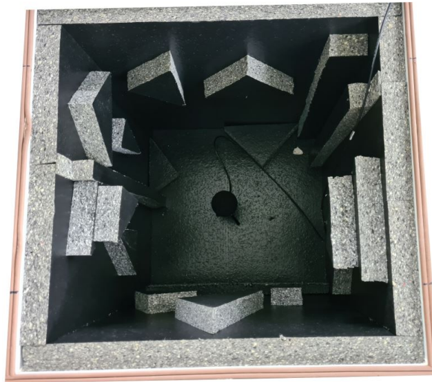
FIGURE 2.5 – Intérieur de la chambre semi-anéchoïque avec son microphone placé au fond.
