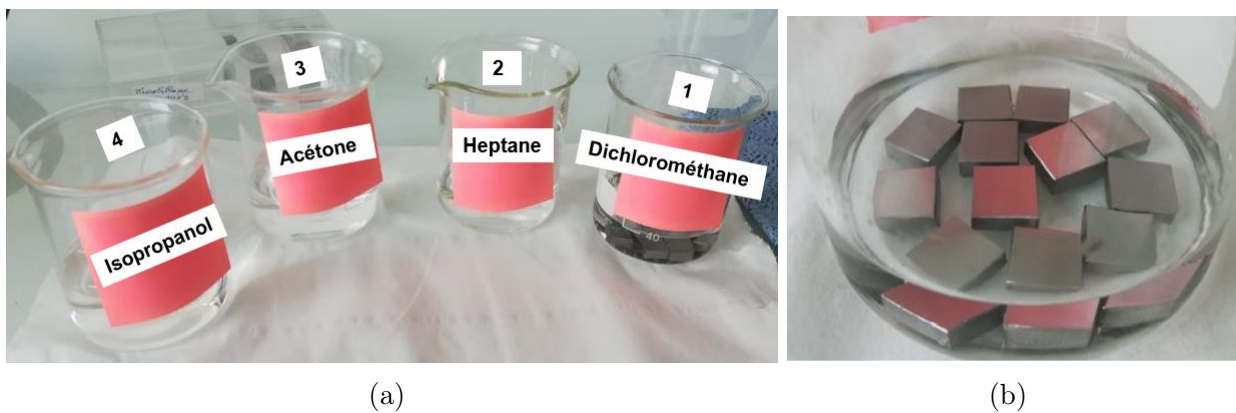
FIGURE 2.10 – Protocole pour le nettoyage des glisseurs. (a) : bains chimiques des quatre solvants avec leur ordre d'utilisation. (b) : vue des glisseurs entièrement immergés.
