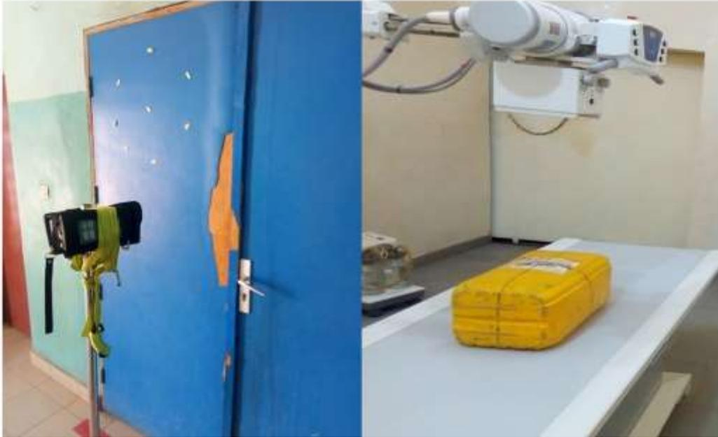
*Figure 27 : Positionnement du radiamètre derrière la porte du couloir lors de la mesure des équivalents de dose ambiants*
