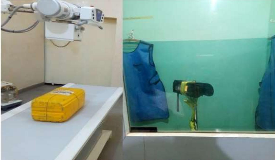
*Figure 26 : Positionnement du radiamètre derrière l'écran en verre lors de la mesure des équivalents de dose ambiants*
