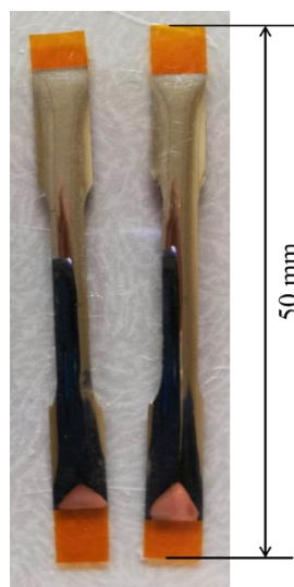
Figure II-19 : Eprouvette de Kapton revêtue utilisée pour les essais de traction
