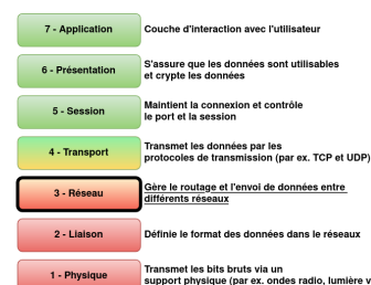
FIGURE 1.1 – Le modèle OSI [3]. Nos travaux se situent au niveau de la couche 3 des réseaux.
