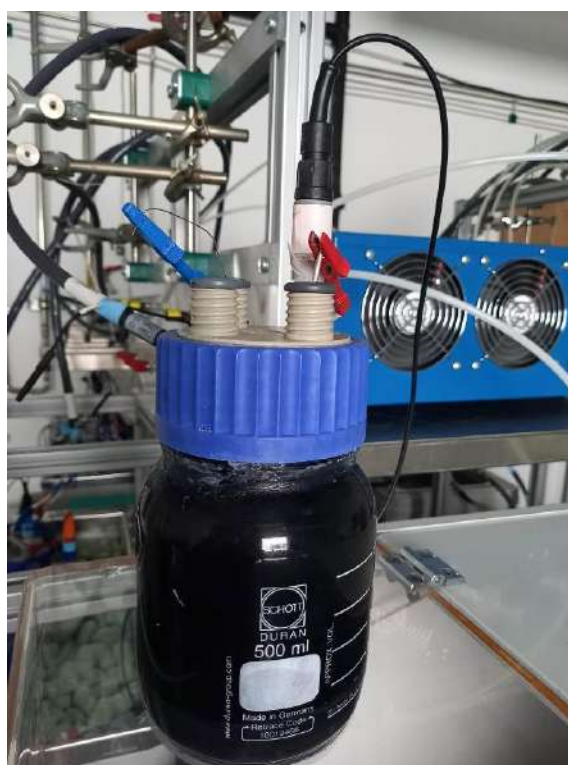
Figure 3 : SBE de 750 ml alimenté en batch avec des eaux usées synthétiques et inoculé à 20 % avec le SCD.
