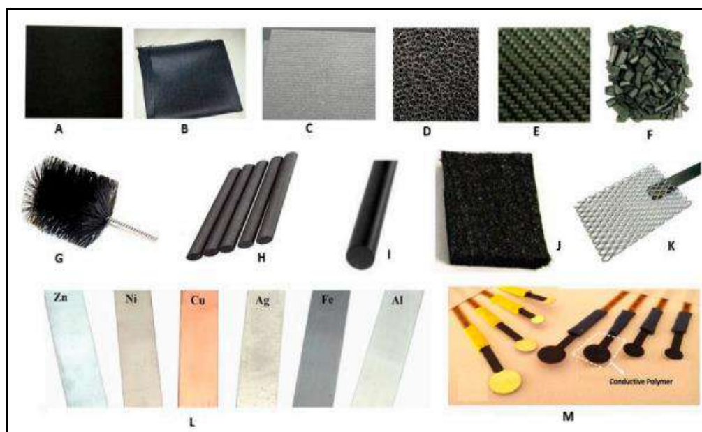
Figure 9 : Les électrodes couramment utilisées : (A) papier de carbone, (B) tissu de carbone, (C) fibre de carbone, (D) carbone vitrifié réticulé, (E) maille de carbone, (F) granules de graphite granulé graphitiques, (G) brosses de carbone, (H) tige de graphite, (I) graphite polycristallin, (J) feutre de carbone, (K) Grille de platine, (L) différentes plaques d'électrodes métalliques, (M) plaques à base de polymère conducteur (Yakoob et al., 2020).
