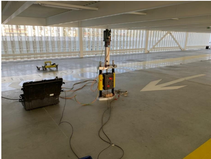
(b) Shaker excitant le plancher
