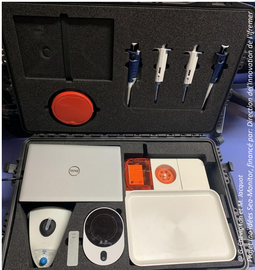
Figure 43 : Image de la valise développée dans le cadre du projet SEA-MONITOR financé par la Direction de l'Innovation de l'Ifremer pour améliorer la surveillance en temps réel des agents pathogènes viraux des mollusques marins.
