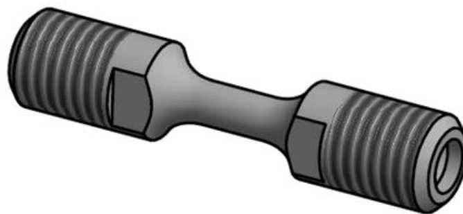
Figure VI-1 : Design des éprouvettes pour les essais cycliques plastiques
