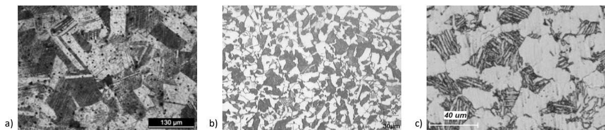
Figure II-1 : Images microscope de la microstructure des matériaux retenus ((a) 316L [71], (b) C35 [72], (c) TA6V [73])
