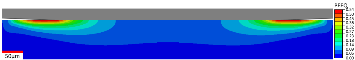
Figure VI-10 : Champ de déformation plastique cumulée (PEEQ) sous le contact après 20 cycles (acier C35, P = 500\text{N/mm} , Q^* = 250\text{N/mm} , R_c = 40\text{mm} , d = 12\mu\text{m} , calcul élasto-plastique)
