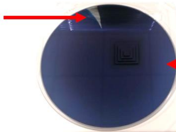
Figure 4 : Photo d'un défaut d'étalement de type comète sur une plaque de silicium 300mm
