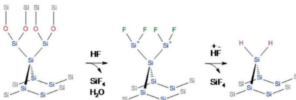
Figure 9 : Formation de la passivation du silicium par des liaisons Si-H après une distribution de HF
