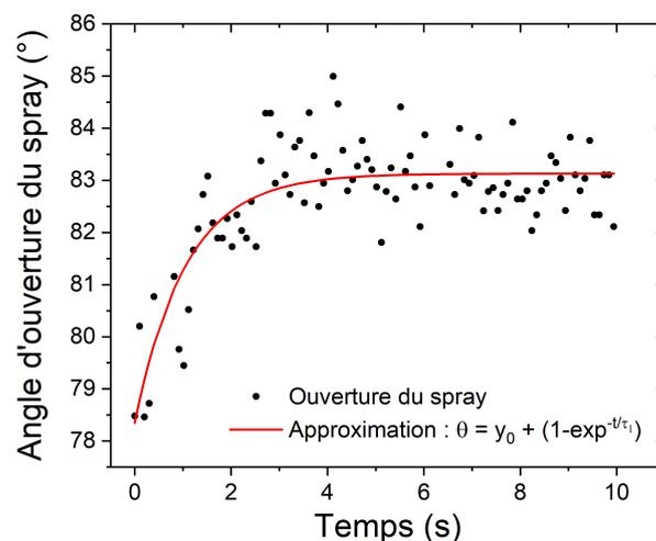
FIGURE 5.12 – Exemple d'évolution temporelle de l'angle d'ouverture  $\theta$ .
