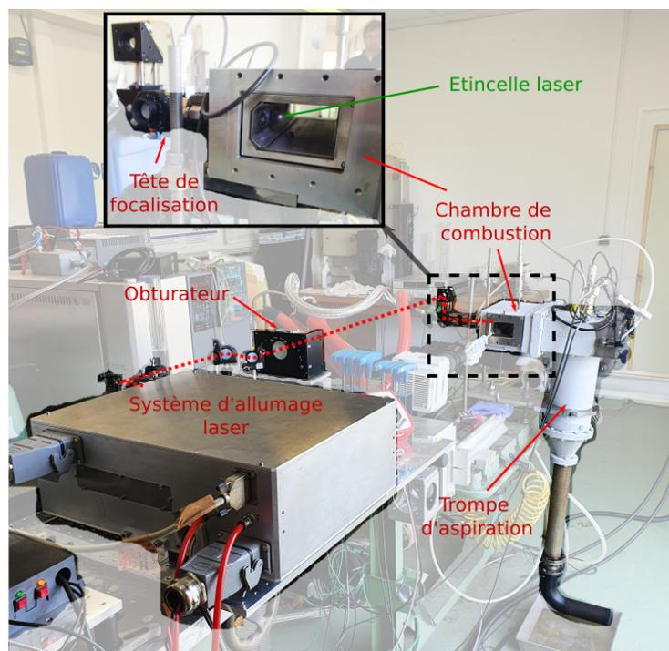
FIGURE 4.5 – Photo du montage expérimental des essais d'allumage.
