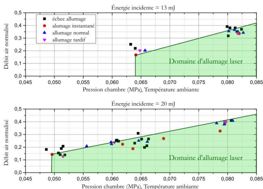
FIGURE 1.23 – Succès d'allumage pour un couple de pression et de débit d'air donné à température ambiante et énergie incidente constante. Un allumage instantané correspond à un temps d'allumage inférieur ou égal à 1,2 s, un allumage normal à un temps compris entre 1,2 s et 2,3 s, enfin un allumage tardif correspond à un temps d'allumage supérieur à 2,3 s [2].
