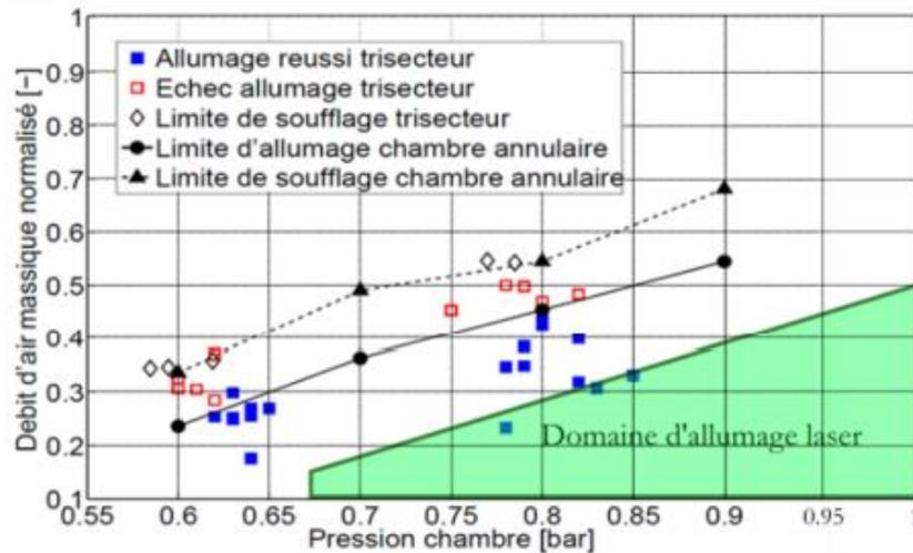
FIGURE 1.24 – Succès d'allumage pour un couple de pression et de débit d'air donné à  $-30\text{ °C}$  réalisé avec une bougie à arc conventionnelle (extrait de la thèse de G.Linassier [49] partie 5.11 p. 218) [2].
