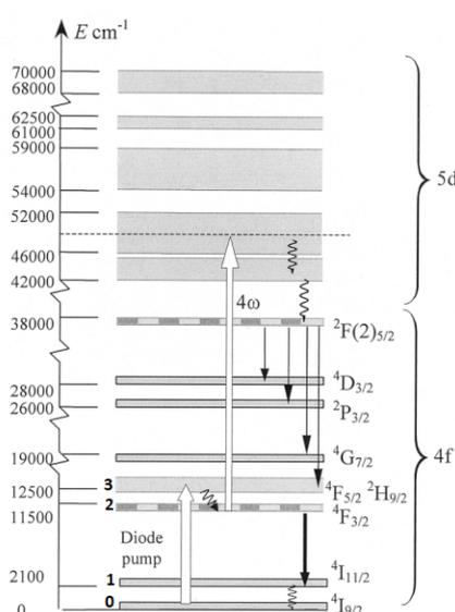
FIGURE 3.1 – Diagramme d'énergie des ions  $Nd^{3+}$  [56].
