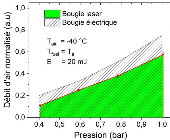
FIGURE 4.14 – Domaine d'allumage laser (système LAMA) de la maquette trisecteur, pour des impulsions de 20 mJ, une température de l'air de  $T_{air} = -40\text{ °C}$  et une température du carburant  $T_{fuel} = 25\text{ °C}$ .
