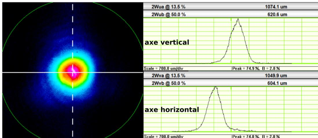
FIGURE 2.11 – Profil du faisceau laser collimaté en sortie de la bougie laser.
