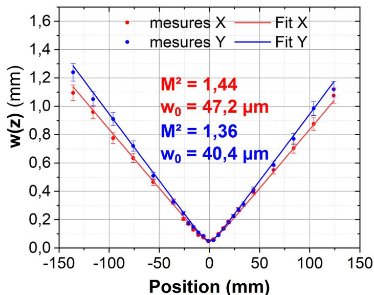
FIGURE 2.12 – Mesure du  $M^2$  des impulsions.
