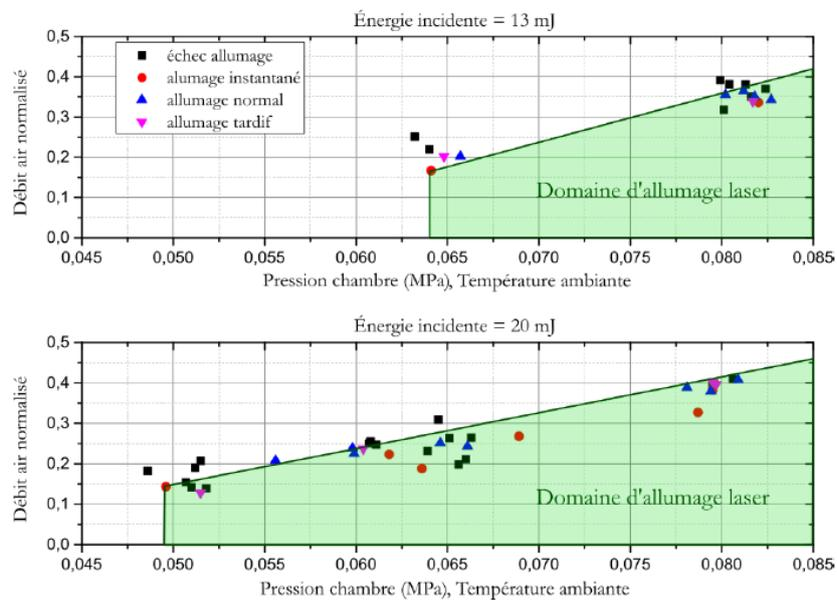
FIGURE 4.8 – Domaine d'allumage obtenu avec le système laser STN [2].
