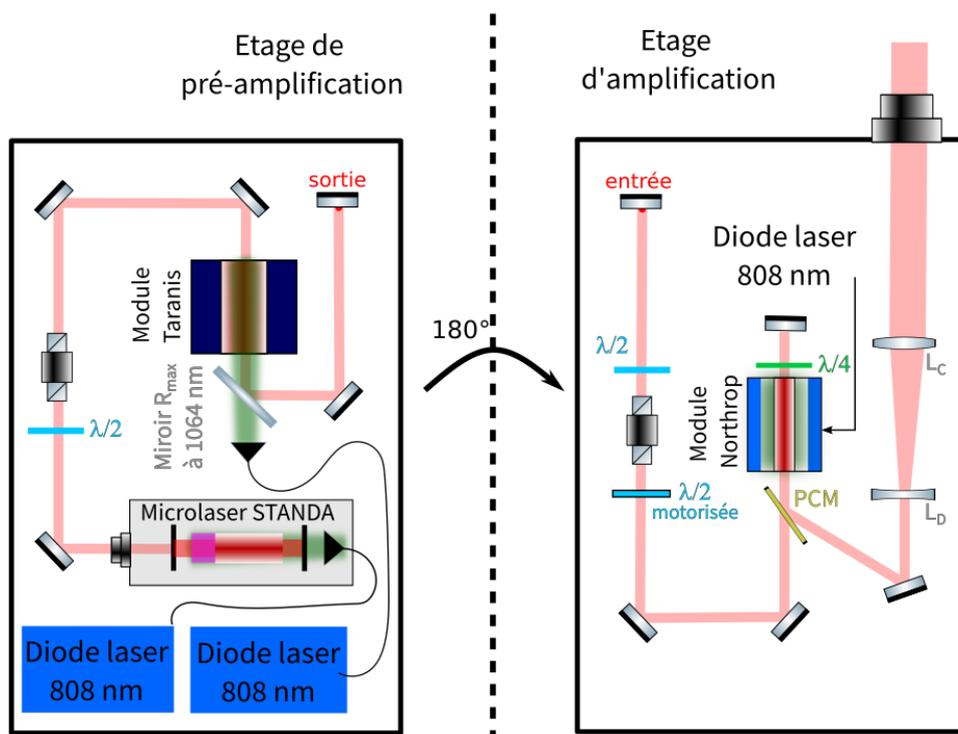
FIGURE 2.5 – Schéma du système d'allumage laser LAMA.
