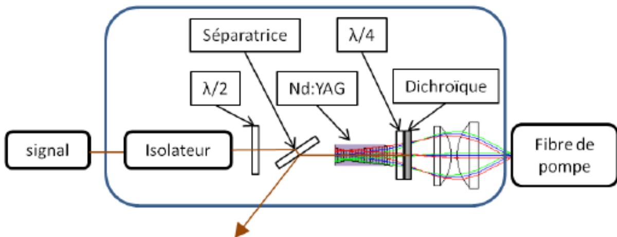
FIGURE 1.16 – Schéma du second étage d'amplification. [1].
