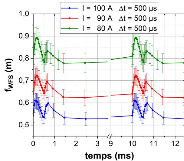
FIGURE 3.7 – Évolution temporelle des effets de lentille induite avec un laser sonde à 1064 nm, pour une durée de pompage de 500 µs et pour plusieurs courants.
