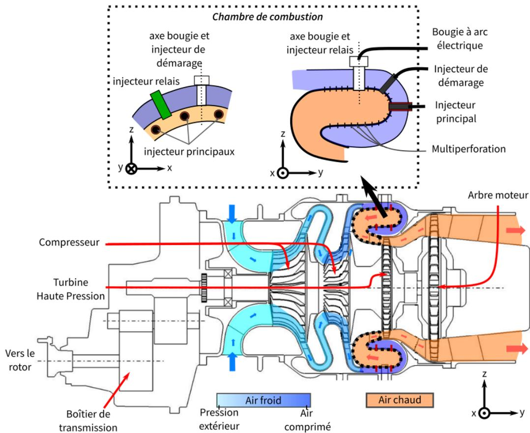
FIGURE 5.1 – Schéma d'un turboréacteur d'hélicoptère [3].
