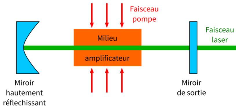
FIGURE 1.5 – Schéma de principe d'une cavité laser.
