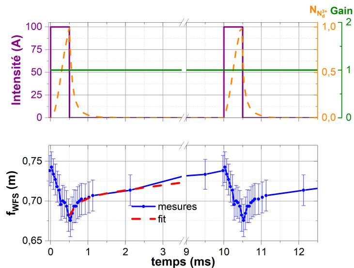
FIGURE 3.9 – Comparaison entre l'évolution temporelle de la focale induite à 532 nm (en bleu) avec le créneau de pompage (en violet), avec le gain optique (en vert) et avec l'évolution de la population des ions  $Nd^{3+}$  excités (en violet). La courbe rouge correspond à la régression exponentielle de la relaxation.
