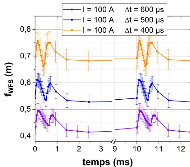
FIGURE 3.8 – Évolution temporelle des effets de lentille induite avec un laser sonde à 1064 nm, pour un courant de 100 A et pour plusieurs durées de pompage.
