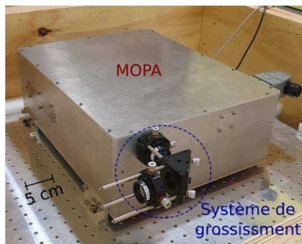
FIGURE 2.6 – Photo du système d'allumage laser
