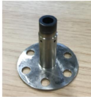
FIGURE 4.4 – Photo d'un fourreau de bougie électrique.
