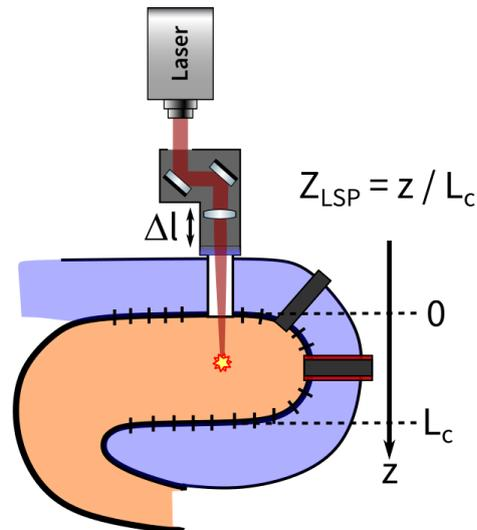
FIGURE 5.3 – Schéma du montage des essais d'allumage.
