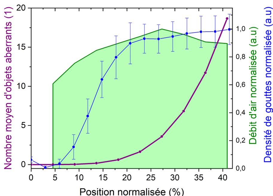
FIGURE 5.19 – Comparaison entre le nombre d'objets aberrants, la densité de gouttes et le domaine d'allumage en fonction de la position.
