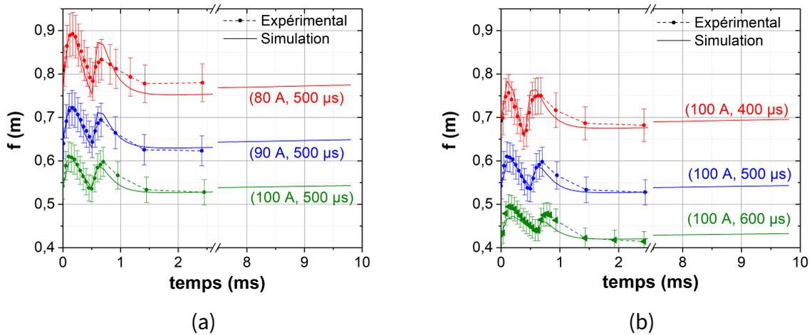
FIGURE 3.16 – Comparaison entre la focale simulée et la focale mesurée dans le cas où les impulsions sont à 1064 nm et pour différents paramètres de pompages.
