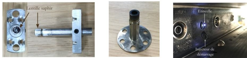
FIGURE 1.21 – Photo du système de focalisation (à gauche, du fourreau d'une bougie conventionnelle, et du plasma créé en chambre)[2].
