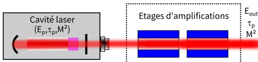
FIGURE 2.1 – Principe de fonctionnement d'un système MOPA.
