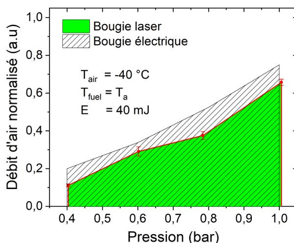
FIGURE 4.15 – Domaine d'allumage laser (système LAMA) de la maquette trisecteur, pour des impulsions de 40 mJ, une température de l'air de  $T_{air} = -40\text{ °C}$  et une température du carburant  $T_{fuel} = 25\text{ °C}$ .
