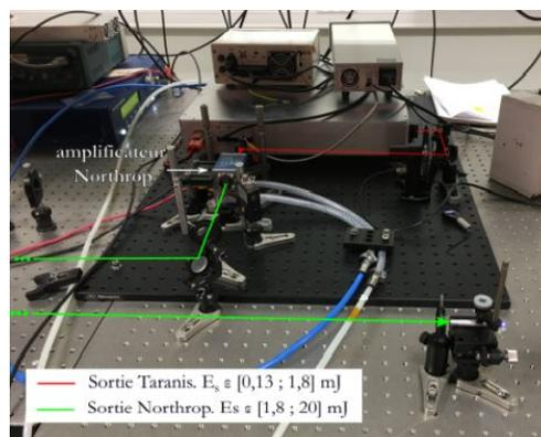
FIGURE 1.17 – Photo du montage Standa-Taranis-Northrop (STN) [2].
