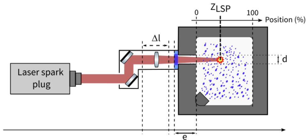
FIGURE 2.13 – Schéma de principe de la tête de focalisation.
