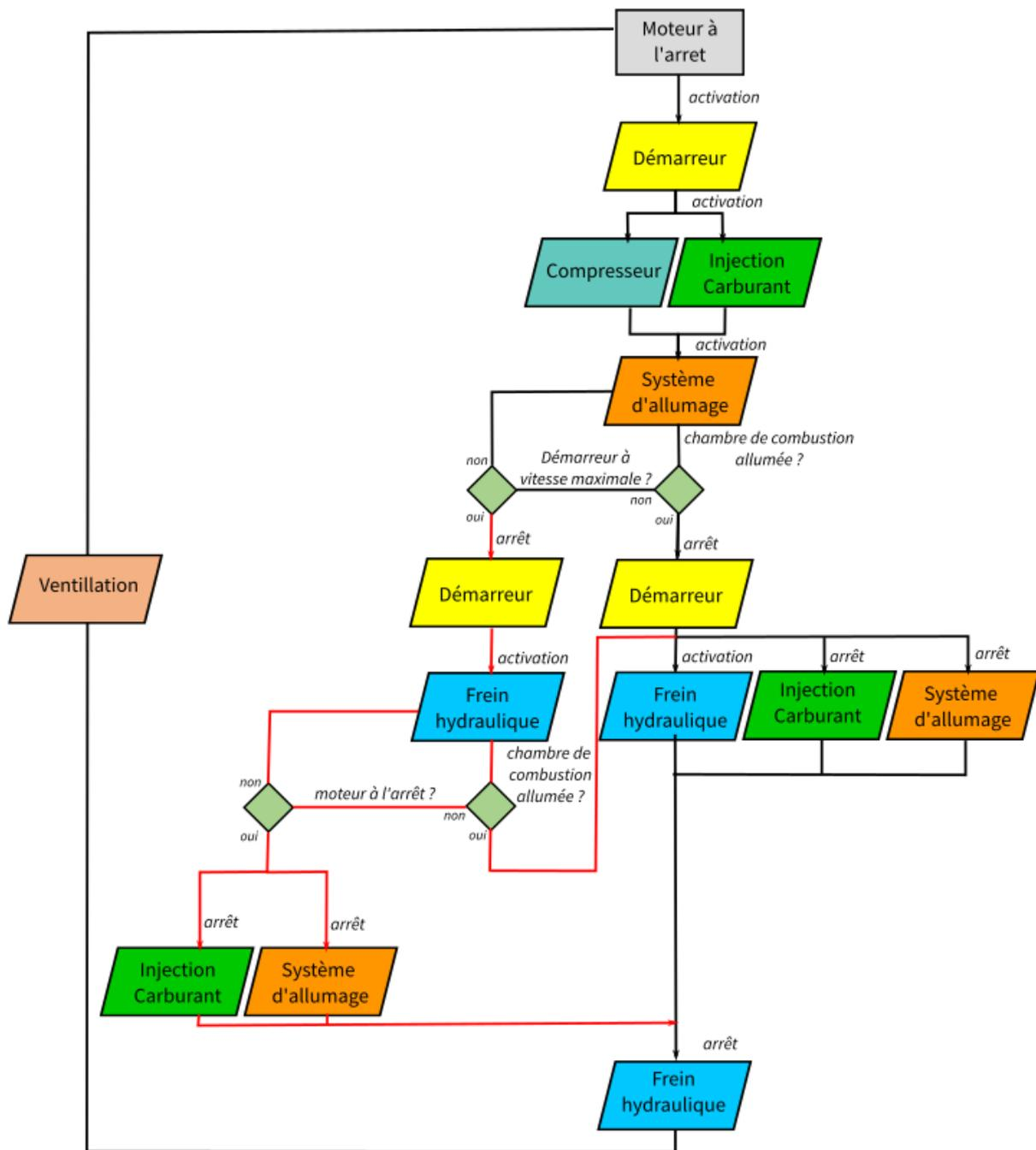
FIGURE 5.4 – Protocole de démarrage d'un turboréacteur.
