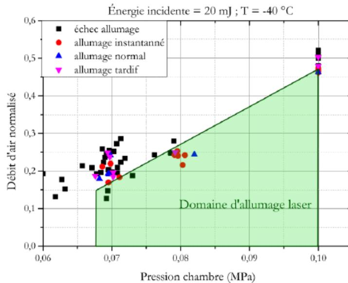
FIGURE 4.13 – Domaine d'allumage laser (système ECLAIR) de la maquette trisecteur, pour une température de l'air de  $T_{air} = -40\text{ °C}$  et une température du carburant  $T_{fuel} = 25\text{ °C}$  [2].
