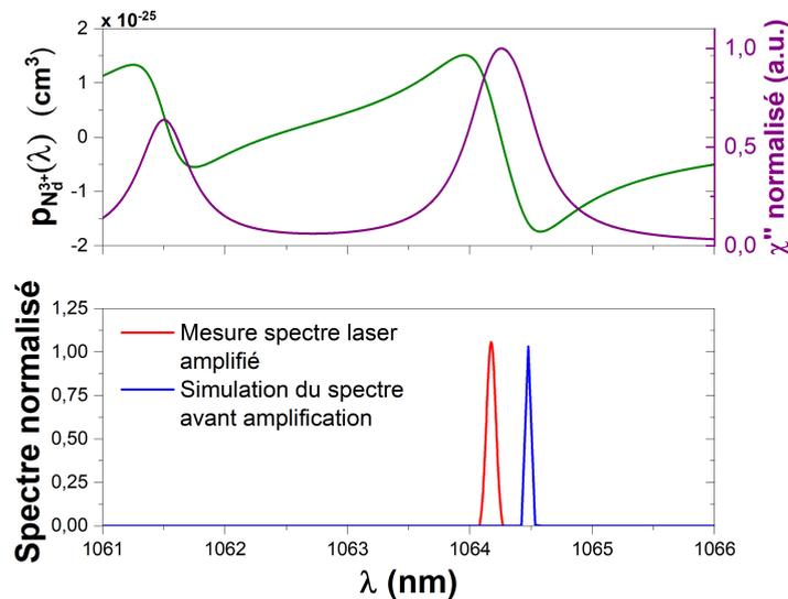
FIGURE 3.12 – Évolution de la polarisabilité des ions  $Nd^{3+}$  en fonction de la longueur d'onde de la source laser (vert). Évolution de la partie imaginaire de la susceptibilité en fonction de la longueur d'onde (violet). Spectre du laser avec (rouge) et sans (bleu) amplification.
