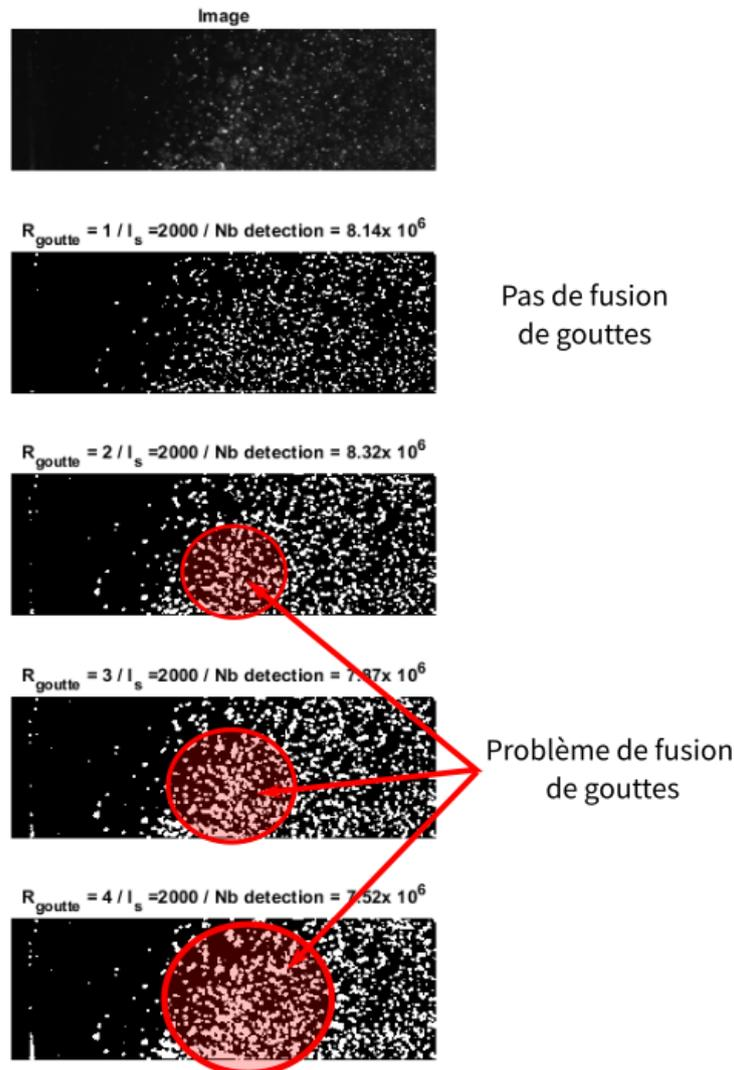
FIGURE 5.15 – Étude paramétrique pour le choix de  $R_{goutte}$ . La première image correspond à une section de notre zone d'intérêt et les autres images correspondent à l'image binarisée pour un seuil d'intensité fixé et pour différents rayons de filtre morphologique.
