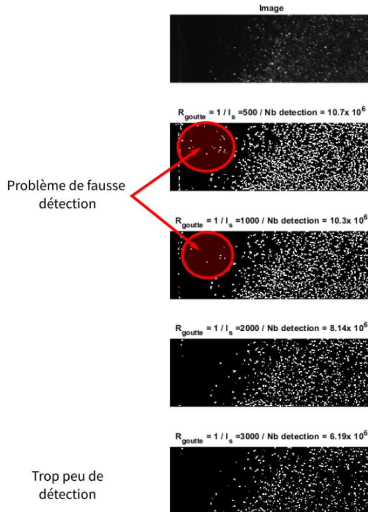
FIGURE 5.16 – Étude paramétrique pour le choix de  $I_{seuil}$ . La première image correspond à une section de notre zone d'intérêt et les autres images correspondent à l'image binarisée pour un rayon de filtre morphologique fixé et différentes intensités seuil.
