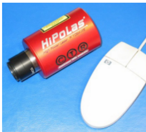
FIGURE 1.11 – Photo de la deuxième génération du laser HiPoLas [42].
