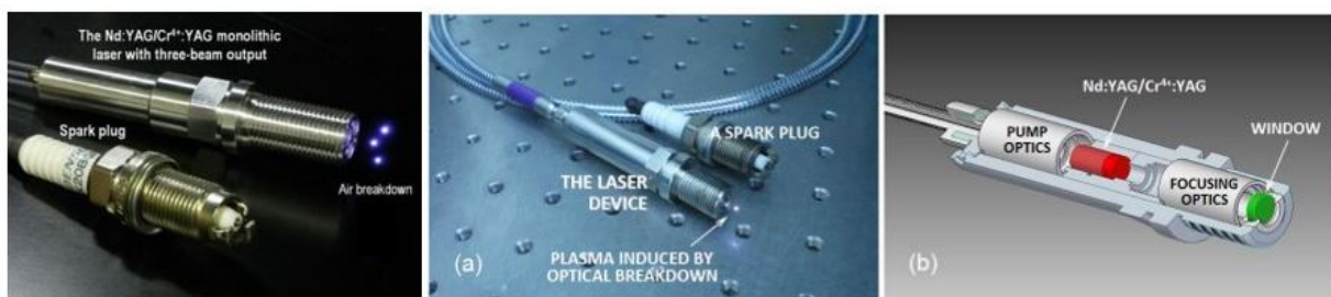
FIGURE 1.8 – À gauche : premier allumeur multipoints. Au centre : photo de l'allumeur monopoint. À droite : schéma de l'allumeur monopoint [39, 40].
