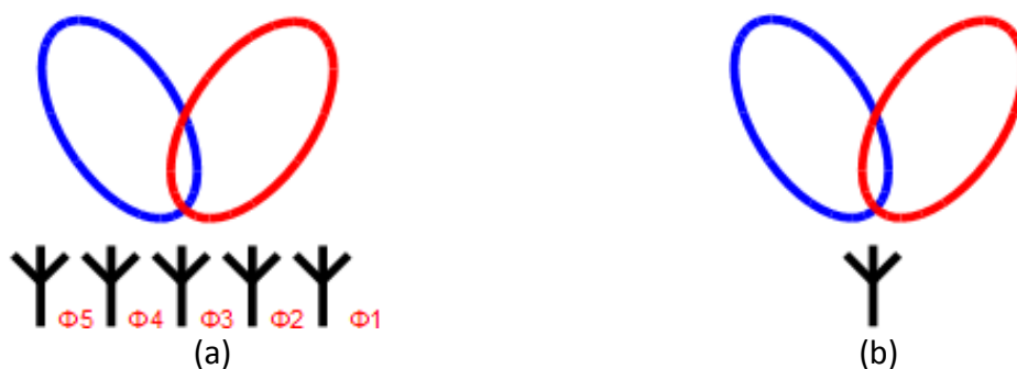
fig. 5 a. Réseau phasé, b. antenne reconfigurable
