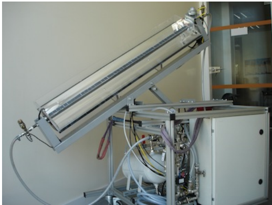
FIGURE 4.12 – Configuration 1.2 du concentrateur, installé sur son banc de test
