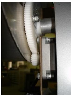
FIGURE 4.2 – Transmission par pignon entre le moteur et le concentrateur
