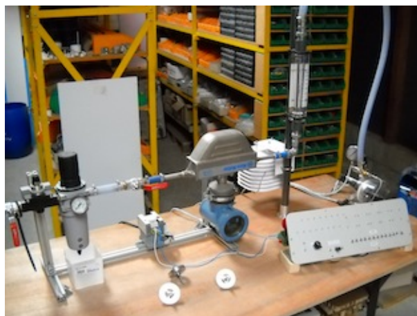
FIGURE 8.2 – Le banc de test de la première turbine Tesla. L'air comprimé entre par le régulateur de débit à gauche. Le débit est ensuite mesuré par le débitmètre massique et le rotamètre avant de rentrer dans la turbine, à droite derrière la platine de commande du banc de charge. Au premier plan, trois des quatre rotors testés.
