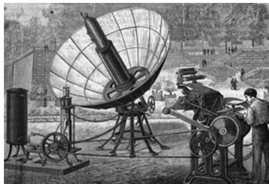
FIGURE 1.16 – Utilisation du concentrateur parabolique d'Abel Pifre. Le 6 août 1882, il imprime le « Journal du Soleil » à raison de 500 copies par heure [101]
