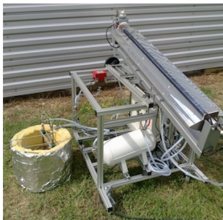
FIGURE 5.2 – Banc d’essai mobile, installé à l’extérieur avec le concentrateur 1.1 incliné
