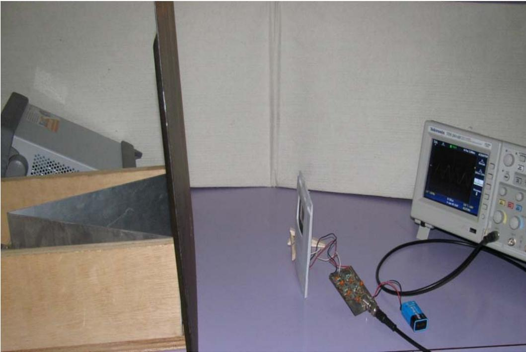
FIG. 4.5: Le dispositif de mesure incluant une plaque de carbone à mesurer.
