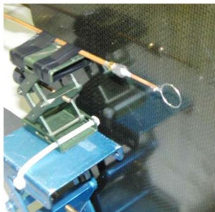
FIG. 7.2: Photographie du dispositif de mesure de l'atténuation de la peau carbone. Dispositif avec la peau de carbone en place.
