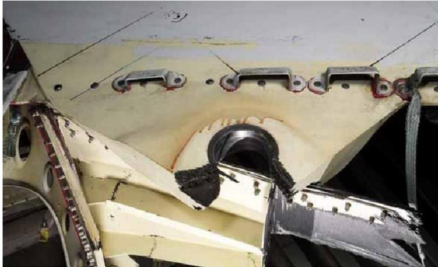
FIG. 2.15: Photo de la zone de rupture du stabilisateur vertical du vol American Airlines 587 [33]
