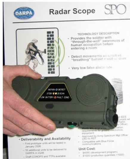
FIG. 5.7: Le dispositif de détection de présence au travers des murs RADAR Scope [69].
