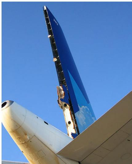
FIG. 2.16: Photo de la queue du vol Air Transat 961 [34]. On remarque les restes du gouvernail accrochés à la base de la queue.
