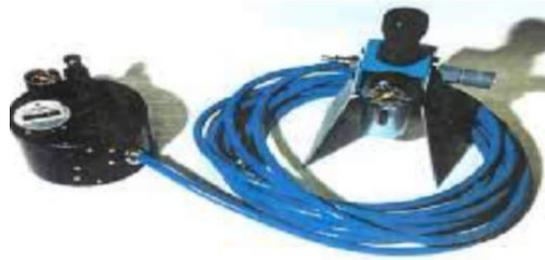
FIG. 2.19: Le dispositif ELCH#1 d'inspection sous vide d'airbus [38].
