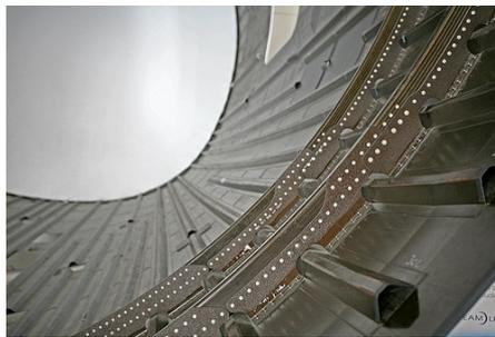
FIG. 2.3: Fuselage du 787 en carbone laminaire [4]
