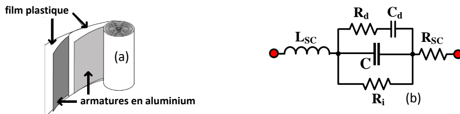
Fig. 4-34 : Condensateur : (a) type diélectrique plastique à film métallisé ; (b) modèle circuit équivalent [EUROS]
