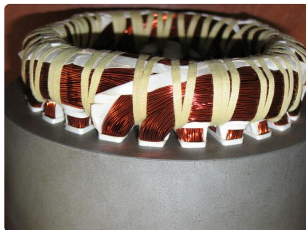
Fig. 2-16 : Exemple de têtes de bobine de l'actionneur pour l'application ECS électrique
