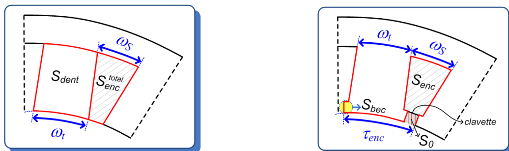
Fig. C. 2 : Visualisation des surfaces de dent et d'encoche : (a) sans bec d'encoche ; (b) avec bec d'encoche
