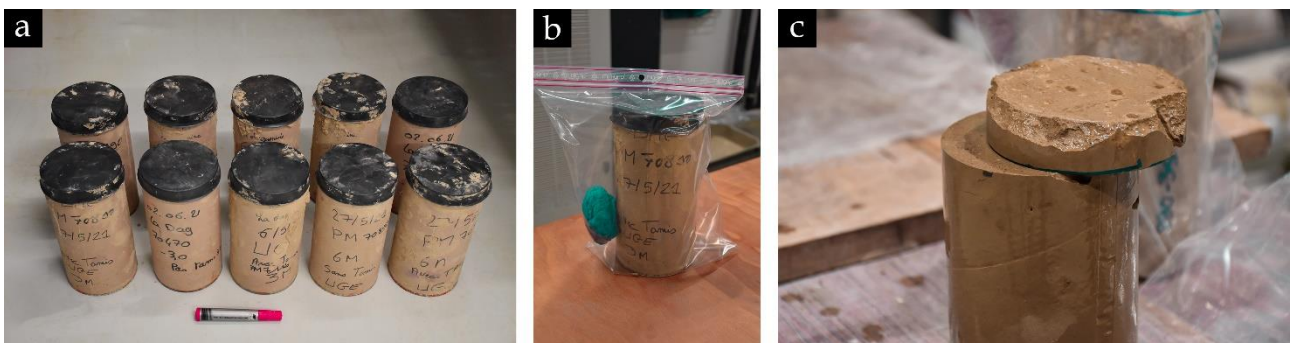
Fig. 52. (a) Huit éprouvettes moulées sur le site LA stockées en laboratoire ; (b) Eprouvette dans une double enveloppe hermétique ; (c) Eprouvette retaillée pour le test de résistance à la compression simple
