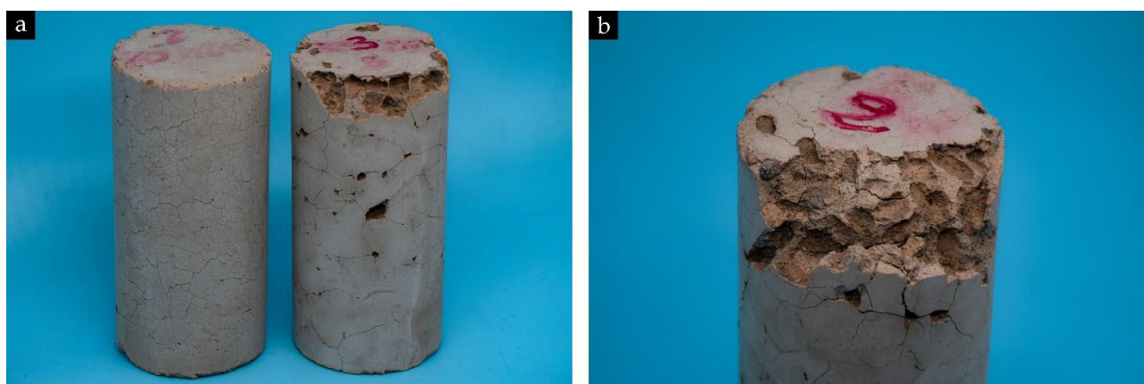
Fig. 265. (a) Deux éprouvette de VOS-MI-B avec P_{3DS} de 0 % et 15 % (de gauche à droite) après 13 cycles (B) ; (b) Eprouvette de VOS-MI-B avec P_{3DS} de 25 % après 24 cycles (B)
