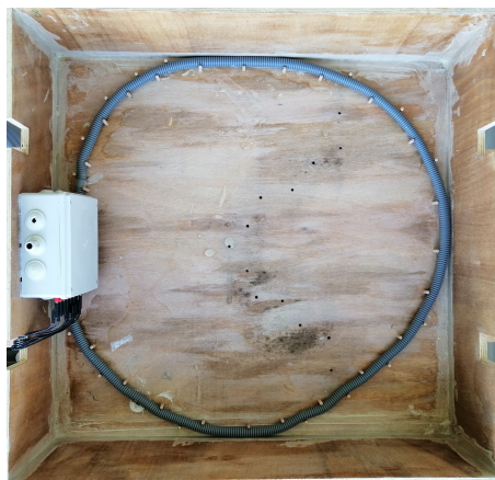
Figure 1.16 – Vue de dessus de la boucle Ministale d'un mètre de diamètre, dans sa gaine grise.
