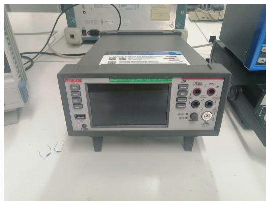
Figure 2.6 – Face avant du DAQ6510, similaire à un multimètre.
