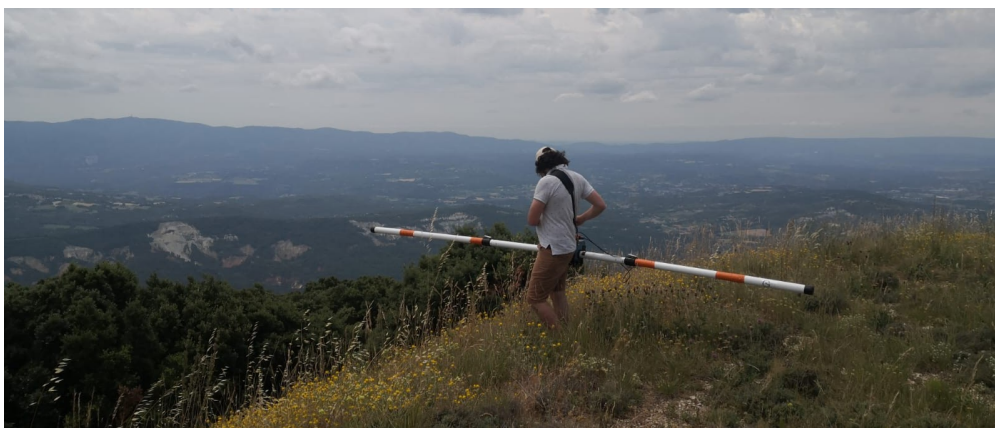
Figure 1.11 – Mesure de conductivité électrique avec l'EM31 sur le site Vertical, le 6 Juillet 2021.
