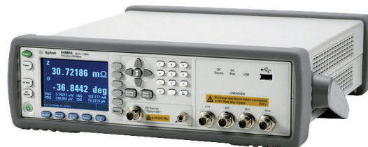
Figure 2.2 – LCRmètre E4980A utilisé. L'interface de la face avant possède 2 parties : à gauche, les boutons et l'écran pour dialogue et les 4 connectiques BNC à droite de l'instrument permettent de brancher en 4 points. Les autres interfaces se situent à l'arrière de l'appareil et ne sont pas visibles ici.
