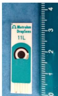
Figure 4.30. Electrode sérigraphiée DropSens<sup>®</sup> 11L utilisée pour la modification des électrodes
