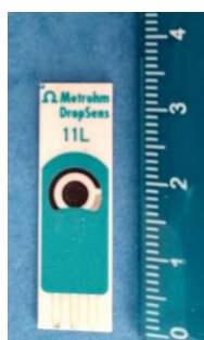
Figure 4.30. Electrode sérigraphiée DropSens® 11L utilisée pour la modification des électrodes
