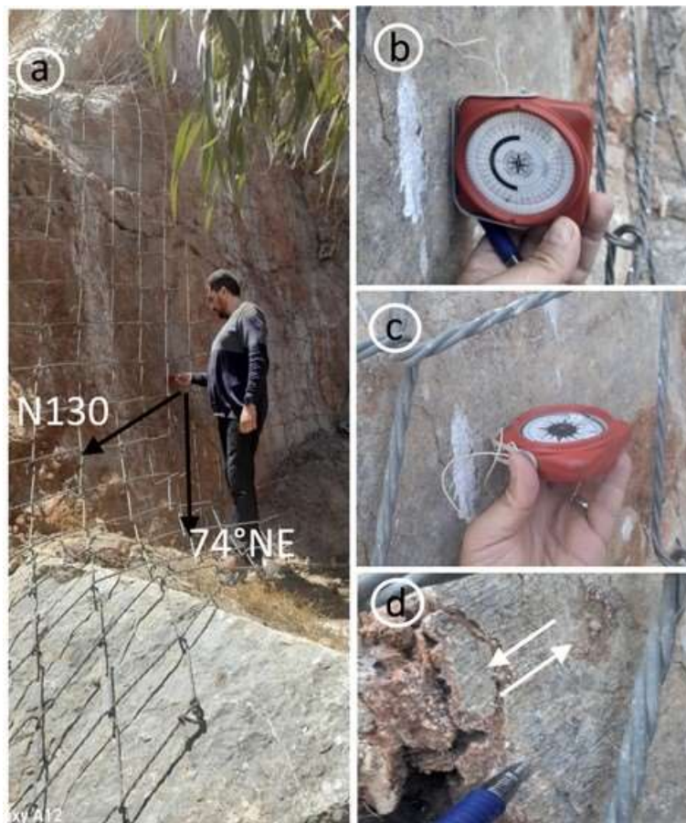
Figure 38: Photographies montrant les différents traits structuraux. (a) miroir de faille orienté NW–SE. (b) mesure de pendage. (c) mesure de direction. (d) stries indiquant la cinématique et le sens de déplacement de la faille.
