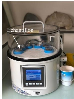
Figure 2-19 : Dispositif d'enrobage sous vide
