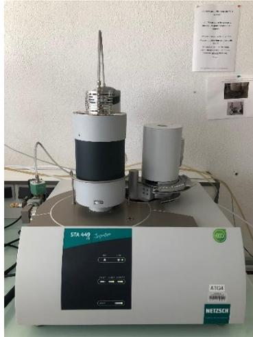
Figure 2-23 : Dispositif de mesure d'ATG
