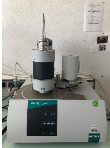
Figure 2-23 : Dispositif de mesure d'ATG
