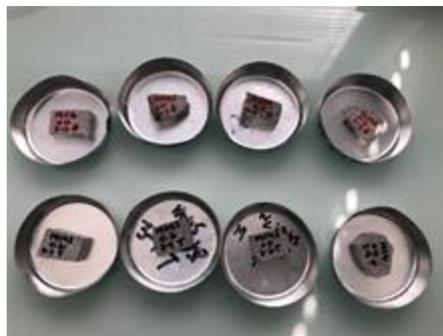
Figure 2-18: Echantillons prélevés pour des observations microscopiques
