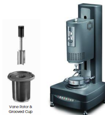
Figure 2-9 : Rhéomètre AR2000Ex et géométrie utilisés
