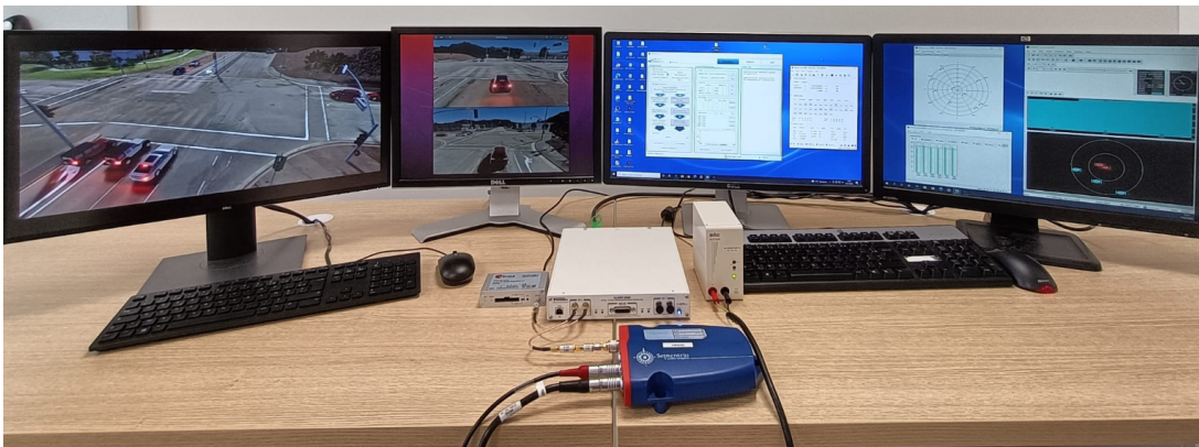
Figure 5.2 – Jumeau numérique avec Stella NGC HIL de M3Systems
