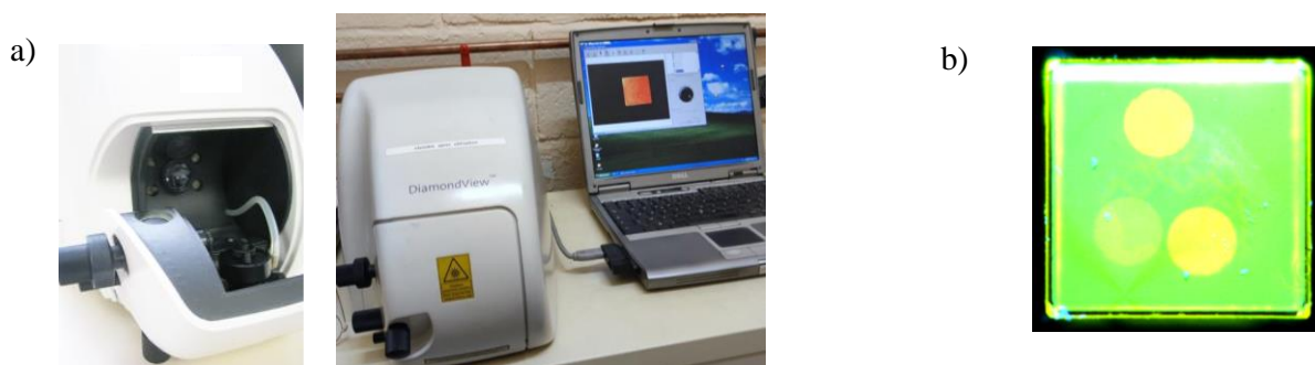
Figure 2.14 : a) Schéma du dispositif d'acquisition d'images de photoluminescence illuminé sous UV profond appelé Diamond View™. b) Illustration d'une figure de fluorescence d'un diamant synthétique CVD fait sur un substrat HPHT et implanté à différentes profondeurs avec des ions N_2^+ (tâches circulaires jaunes).
