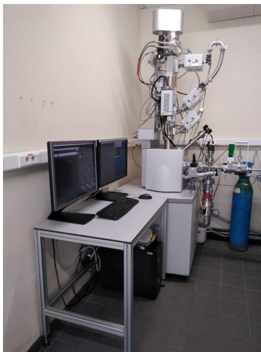
Figure 2.5 : Colonne à faisceaux d'ions (FIB : Focused Ion Beam) de Orsay Physics disponible à l'IRCP.
