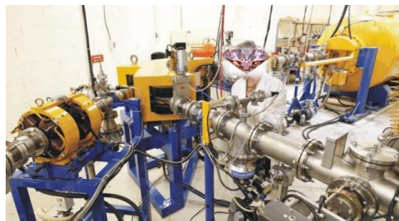
Figure 3.17 : a) Principe de mesure par ERDA et b) dispositif de mesure (Microsonde nucléaire du NIMBE/LEEL) [48].
