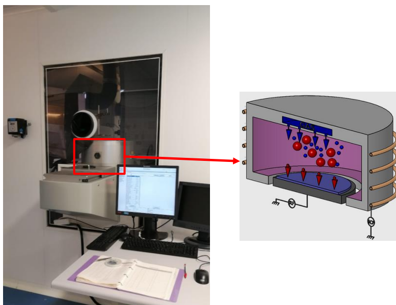
Figure 2.7 : Schéma du réacteur RIE-ICP présent dans la salle blanche C(\text{PN})^2 de l'Université de Sorbonne Paris Nord et utilisé pour les gravures et les dépôts de fluor (système PECVD).
