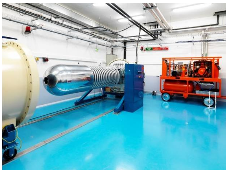
Figure 3.4 : L'accélérateur d'électrons SIRIUS (NEC Pelletron).
