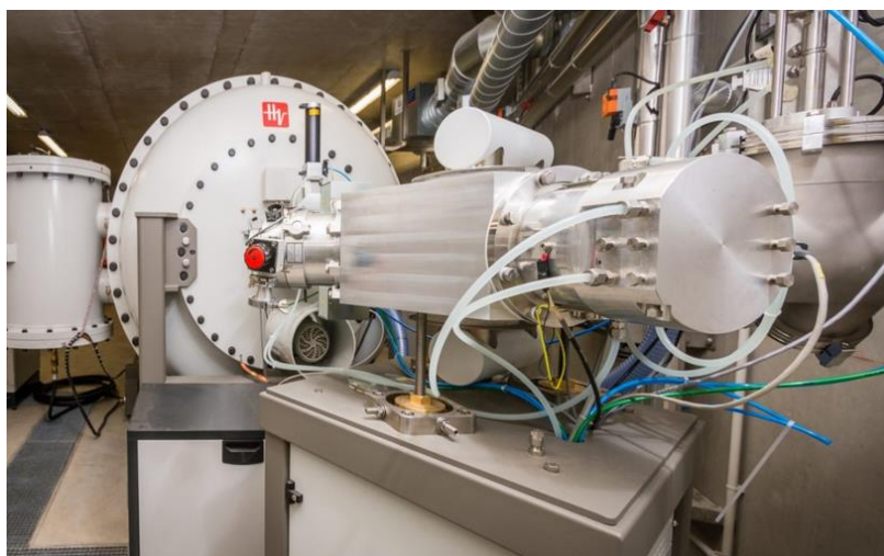
Figure 3.6 : Accélérateur électrostatique d'électrons de l'entreprise ATRON METROLOGY.
