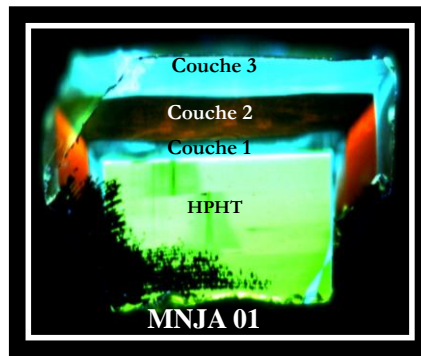
Figure 3.16 : Image de PL obtenue avec le Diamond view TM pour les films CVD sur substrats HPHT Ib multicouches (MNJA 01) découpé sur la tranche.
