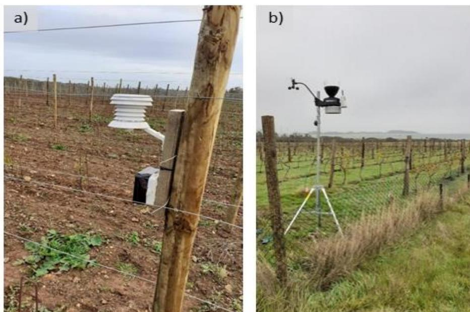
Figure 50 - a) Capteur thermique Tinytag au vignoble du Poulhors, Sarzeau, b) Station météorologique David Vantage Pro dans le Coteau de Liouse, île d'Arz
