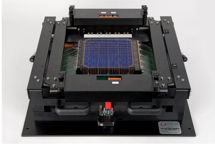
Figure 36. Système de mesure I-V Pasan
