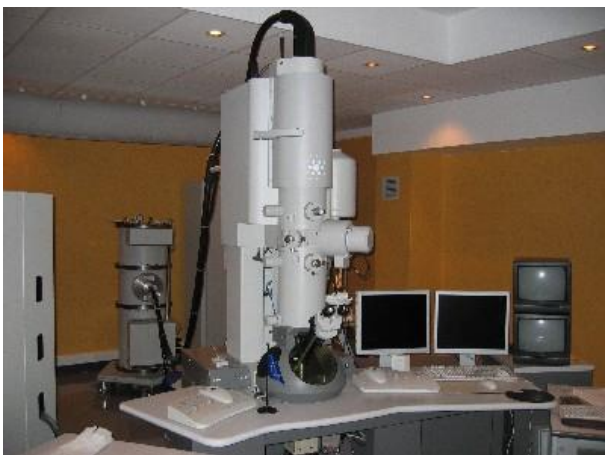
Figure 18. TEM FEI Tecnai G2-20 twin.
