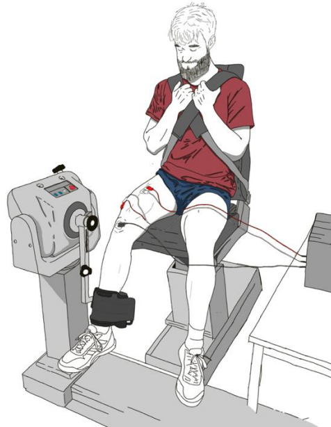
Figure 13 : Contraction maximale volontaire réalisée sur l'ergomètre isocinétique. L'activité EMG des muscles vastus lateralis et rectus femoris est enregistrée par un module biopac.
