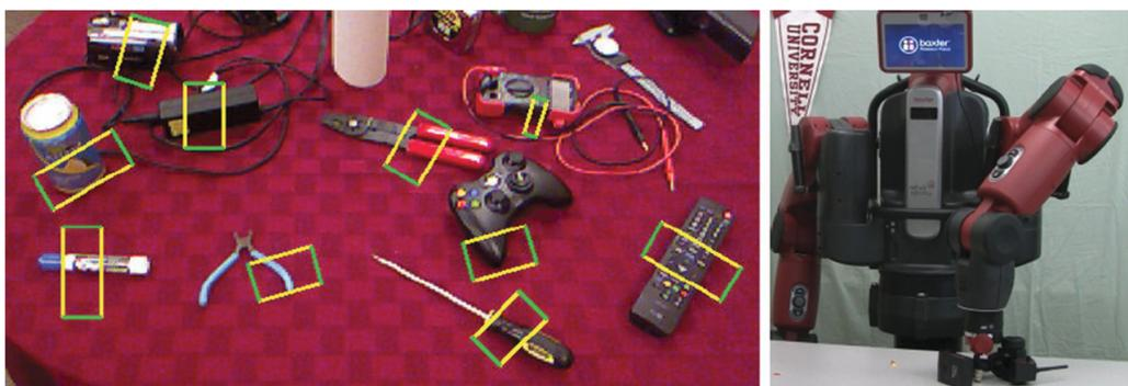
FIGURE I.3 – Exemple de détection de zones de saisie estimée par apprentissage profond pour faciliter la préhension d'objets à l'aide d'un bras manipulateur. Crédit image : Lenz et al. [2015].
