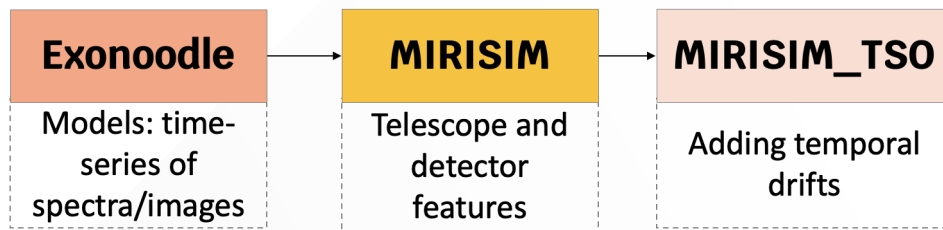
FIGURE 2.13 – Outils de la chaîne de simulation comprenant les packages ExoNoodle , MIRISim et MIRISim-TSO . La dernière étape consiste à l'application du pipeline officiel de réduction des données JWST .
