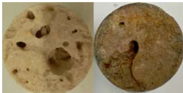
Figure 140 Photographie de chemins préférentiels développées dans des gypses saccharoïdes après altérations par percolation pendant 2 mois. À gauche le faciès pur, à droite le faciès à interlits
