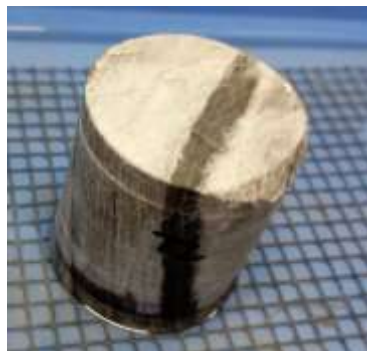
Figure 131 Exemple du changement de coloration avec la saturation d'une éprouvette de gypse orogénique.
